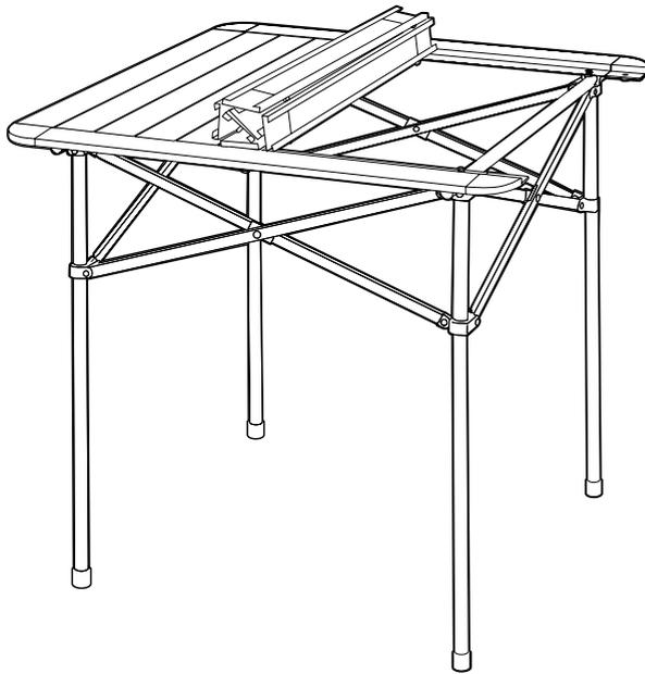
7. Schieben Sie die beiden Kunststoffzapfen in die passende Position. Stecken Sie die Kunststoffzapfen danach in das jeweils dafür vorgesehene Befestigungsloch des Seitenteils, bis sie hörbar einrasten.
