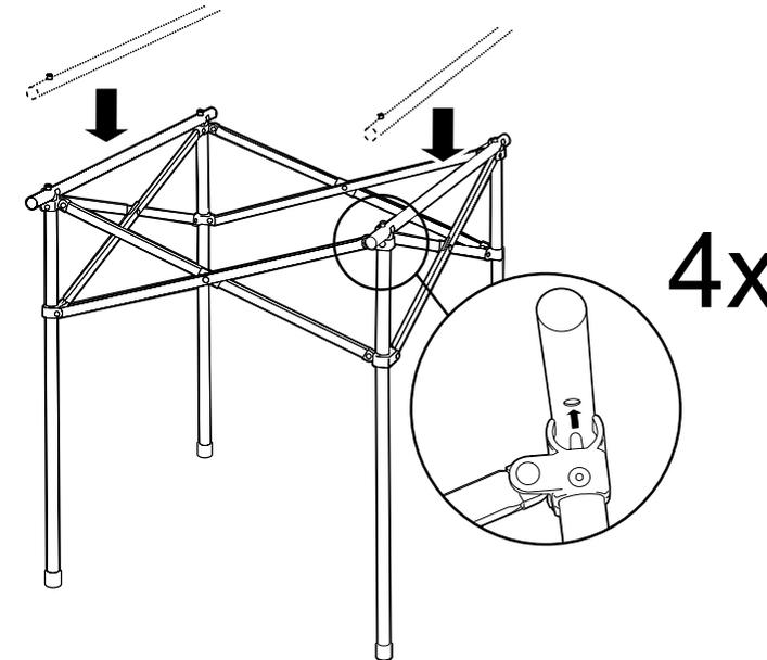
5. Stecken Sie die Seitenteile auf das Untergestell. Achten Sie darauf, dass die Seitenteile an allen 4 Ecken richtig in den Führungen sitzen.
