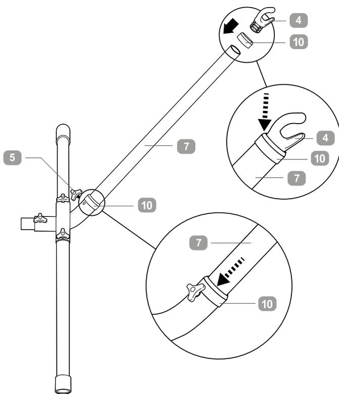
1. Encaixe uma luva de borracha **10** em cada ponta do tubo comprido **7**. De seguida, empurre um tubo comprido **7** em cada esquadro, do lado de cima e no sentido transversal.
