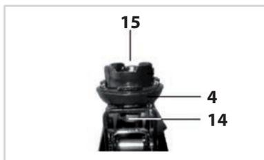
Démontez l'écrou (14) et la vis (15) de la selle (4).
