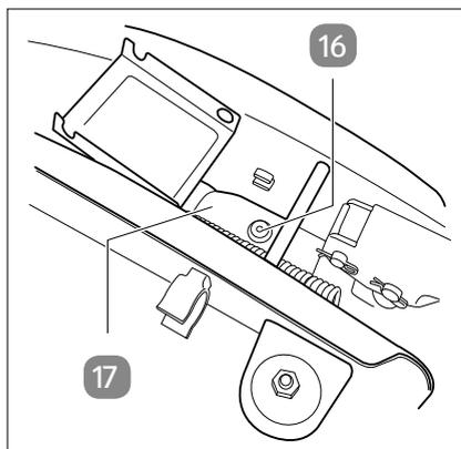
3. Rabboccare con olio ricoprendo l'asta del pistone del cilindro. Fare attenzione a non far fuoriuscire l'olio. Se necessario, usare l'imbuto per il rabbocco dell'olio.
