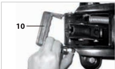
Maak nu een trek-draaibeweging met de draaggreep (10), om het andere oog op de tweede moer vast te laten klikken. Let er daarbij op, dat de greep niet overbelast wordt en breekt.
