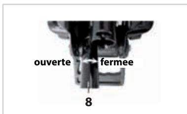
4. Tournez le bras du levier (8) lentement dans le sens des aiguilles d'une montre pour fermer la soupape de vidange (11).
