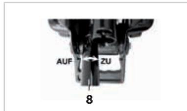
4. Drehen Sie den Hebelarm (8) im Uhrzeigersinn, um das Ablassventil (11) zu schließen.
