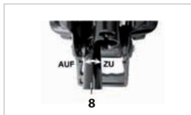
4. Senken Sie den Sattel (4) bzw. Tragarm (3) vollständig ab. Drehen Sie den Hebelarm (8) im Uhrzeigersinn, um das Ablassventil (11) wieder zu schließen.
