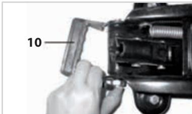
Machen Sie jetzt eine Zieh-Dreh-Bewegung mit dem Tragegriff (10), um die andere Öse an der zweiten Mutter einrasten zu lassen. Achten Sie dabei darauf, dass der Griff nicht überlastet wird und bricht.
