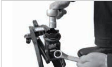
Lösen Sie die Mutter (14) mit z. B. einem Ringschlüssel, während Sie die Schraube (15) kontern.
