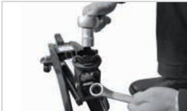
Desserrez l'écrou (14) à l'aide d'une clé à œil, en tenant la vis (15).
