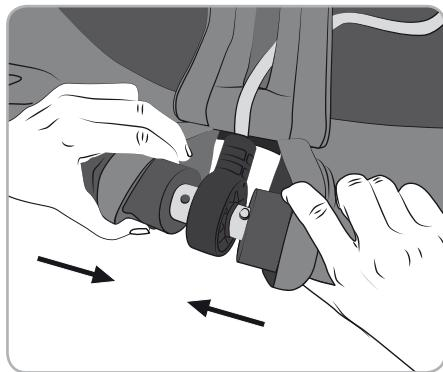
6. Verbinden Sie jetzt die Stangen miteinander und drücken Sie dabei den Federdruckknopf des dünneren Rohrendes herunter. Die Arretierung erfolgt durch das Einrasten und Klicken des Federdruckknopfes.
