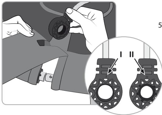
5. Die Kunststoffaufhängung des Seils von oben durch die Öffnung der Lasche mit den Klettböndern schieben. Danach mit der Seite II (siehe Markierung) die Aufhängung auf das dickere Rohr stecken.
