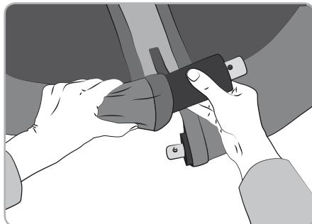
2. Glisser successivement les 4 tubes avec le rembourrage dans les ouvertures prévues du siège.
