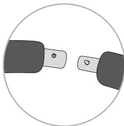
3. Il est nécessaire qu'une extrémité de tube plus épais avec un trou succède à une extrémité de tube avec un bouton-poussoir à ressort.
