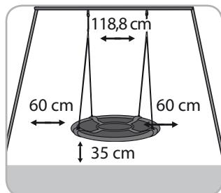
Les points de suspension doivent être distants au minimum de la largeur du siège de la balançoire (+ 10 cm).
