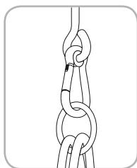
Het oog van de beugel moet haaks op de schommelrichting worden bevestigd. Dit voorkomt overmatige slijtage door het schommelen.
