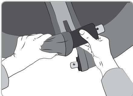
2. Schuif de 4 framebuizen met bekleding na elkaar in de daarvoor bestemde zakken van de zitting.
