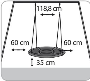
Les points de suspension doivent être distants au minimum de la largeur du siège de la balançoire (+ 10 cm).
