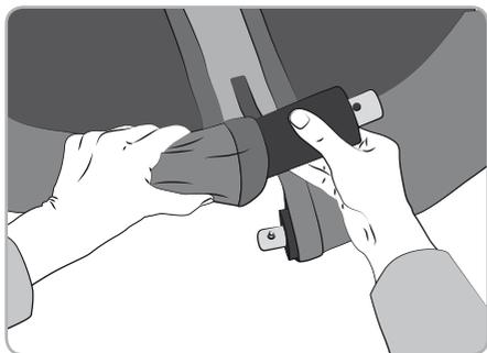
2. Glissez successivement les 4 tubes avec le rembourrage dans les ouvertures prévues du siège.
