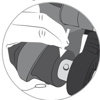
Ouvrir le velcro et déplacer le rembourrage sur le côté. Appuyer sur le bouton-pression à ressort pour séparer les tubes.
