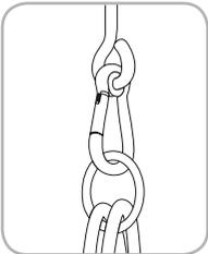
L'œil de la fixation doit être fixé perpendiculairement à la direction du mouvement de la balançoire. Cela empêche une usure trop importante lors de l'utilisation de la balançoire.
