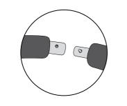
Achten Sie darauf, dass jeweils ein dickeres Rohrende mit Loch auf ein Rohrende mit Federdruckknopf folgt.
