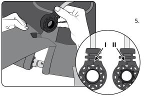
5. Die Kunststoffaufhängung des Seils von oben durch die Öffnung der Lasche mit den Klettbändern schieben. Danach mit der Seite II (siehe Markierung) die Aufhängung auf das dickere Rohr stecken.
