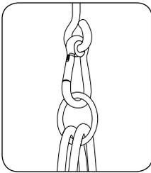
Das Auge der Halterung muss quer zur Schaukelrichtung angebracht werden. Dadurch wird ein zu großer Verschleiß beim Schaukeln verhindert.
