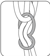
Die Höhe der Nestschaukel kann durch die Öffnungen in dem Verstellerelement eingestellt werden. Dadurch kann die Länge der Seile entsprechend verändert werden. Beim Einstellen der Seillänge sollte niemand auf der Schaukel sitzen. Achten Sie darauf, dass die Seile immer gleichlang sind.
