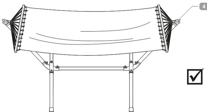
1. Suspendre les œillets du hamac **2** au-dessus des capuchons à crochet **4**.
