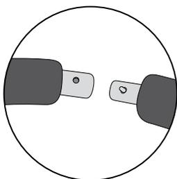
3. Achten Sie darauf, dass jeweils ein dickeres Rohrende mit Loch auf ein Rohrende mit Federdruckknopf folgt.
