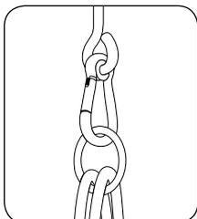
Das Auge der Halterung muss quer zur Schaukelrichtung angebracht werden. Dadurch wird ein zu großer Verschleiß beim Schaukeln verhindert.
