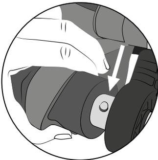
Öffnen Sie das Klettband und schieben Sie die Polsterung zur Seite. Lösen Sie den Federdruckknopf, um dann die Rahmenrohre auseinanderzuziehen.
