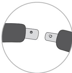
3. Asegúrese de que a cada extremo de tubo grueso con orificio le siga un extremo de tubo con botón con resorte.
