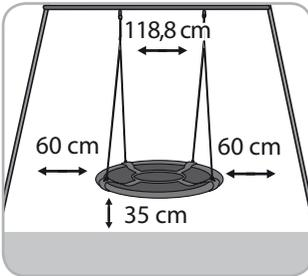
Los puntos de suspensión tienen que estar separados entre sí por al menos el ancho del asiento del columpio (+ 10 cm).
