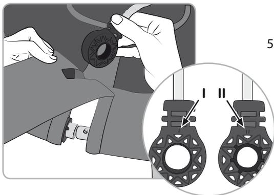
5. Inserte el colgador de cuerda de plástico desde arriba en la abertura de la solapa con el cierre de velcro. A continuación, en el lado II (compruebe la marca), introduzca la suspensión en el tubo grueso.
