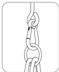
El ojo del soporte tiene que estar montado transversalmente a la dirección del columpio. De este modo, se evita un desgaste mayor en el columpio.
