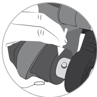
Abra los velcro de resorte de la pestaña y desplace el acolchado hacia un lado. Suelte el botón de resorte para desarmar los tubos de bastidor.
