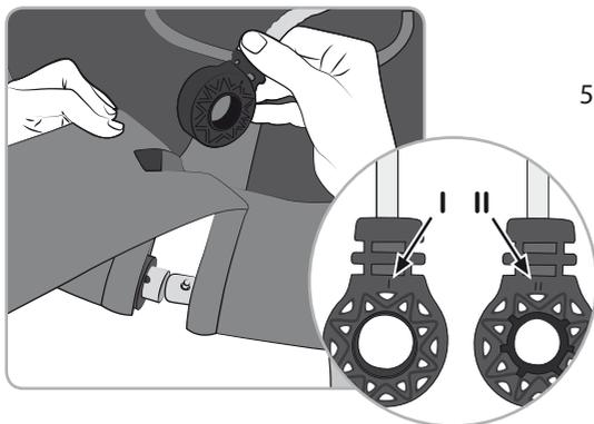
5. Poussez la suspension plastique de la corde par le dessus à travers l'ouverture de l'attache avec les velcros. Puis emboîtez la suspension sur le tube plus épais avec le côté II (voir marquage).
